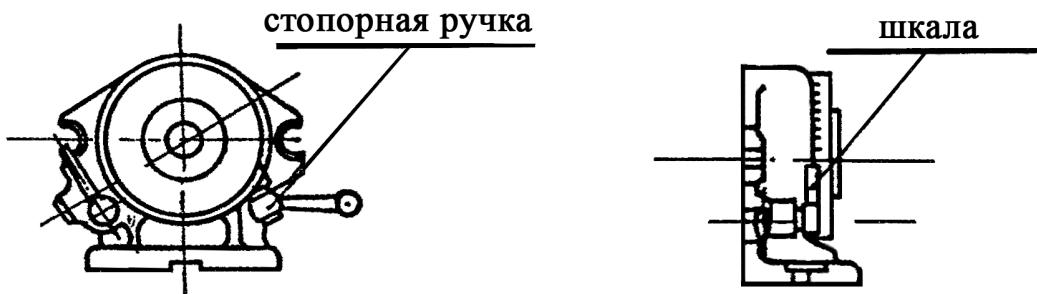
При делении, если делительная пластина не встала в свою позицию, верните шпиндель к предыдущему положению и снова поворачивайте шпиндель в нужную сторону, пока стопорный штырь не зафиксирует нужное положение в прорези диска.
