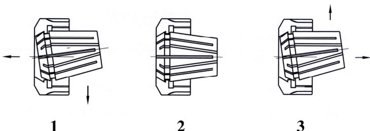
**А.** Очистите наружный конус патрона и внутренний конус шпинделя. Вставьте патрон в отверстие шпинделя. Затяните штрель до полной блокировки патрона.
